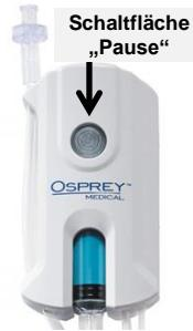
Wenn sich das System im Modus „Pause“ befindet, wird die Berechnung des kumulativen Kontrastmittels ausgesetzt.
