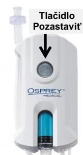
pozastavenia modulu DyeVert Plus EZ Module. LED diódy na striekačke Smart Syringe a module Module budú 10 sekúnd zelené a pozadie na displeji sa vráti do normálneho stavu.
